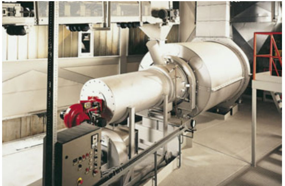
Secador Triplex con generador de gas caliente
